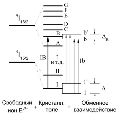
Рис. 1. Штарковские и обменные расщепления уровней на примере мультиплетов 4I_{15/2} и 4I_{13/2} иона \text{Er}^{3+} .
